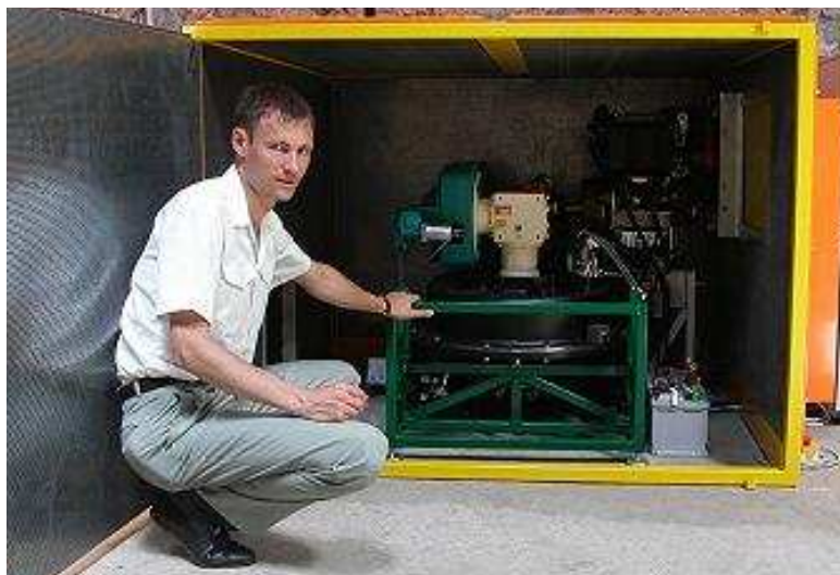
André Gennesseaux, directeur général d'Energistro, présente son prototype fonctionnel de générateur électrique. D'une puissance de 5 kW, il pourrait alimenter une habitation pendant 10 à 20 ans.
